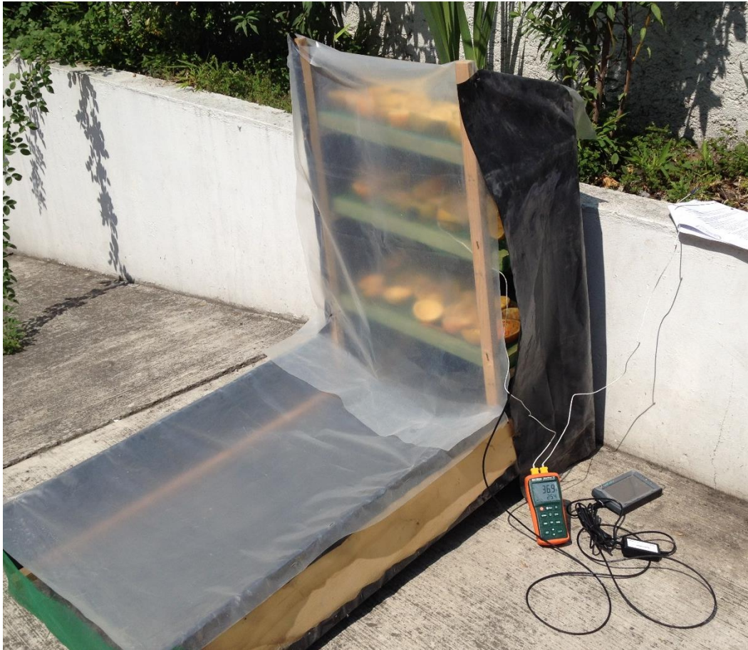
Figura 4.7 Medición de temperatura y radiación solar en deshidratador solar
