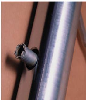
Figura 4.51. Pequeñas barrenas muestreadoras de pared de pozo.
