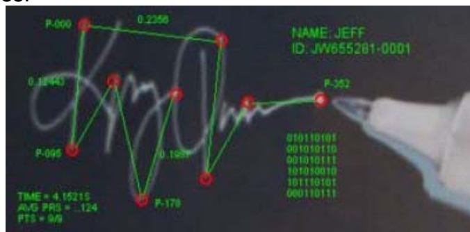
Figura 2.7.- Representación gráfica del reconocimiento dinámico de la firma: Cuando un individuo firma sobre el pizarrón digital, varias mediciones son realizadas y procesadas para comparación.
