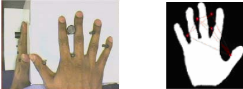
Figura 2.5.- (Izq.) Imagen de la superficie y perfil de la mano, vista por la cámara CCD. (Der.) Imagen de la silueta de la mano incluyendo ejemplos de medición de distancias.
