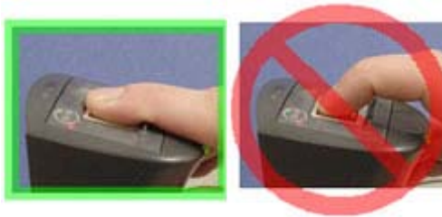
Figura c.3.- Posición correcta e incorrecta del dedo sobre el sensor para el proceso de enrolamiento y verificación.
