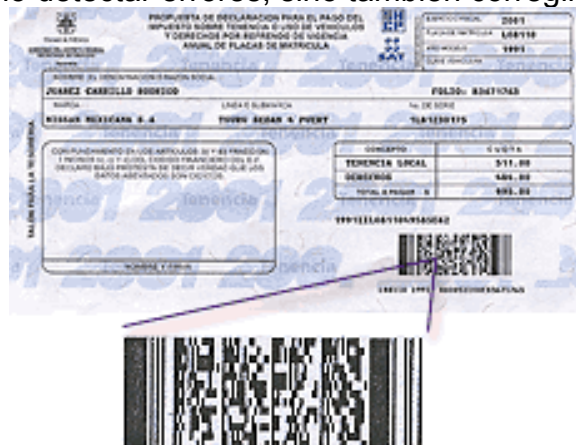
Figura 2.40.- Código de barras en dos dimensiones (específicamente se trata de un código PDF417).
