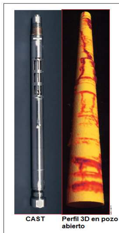
Figura I.8. CAST de Halliburton y Perfil 3D en pozo abierto (Halliburton, 2009).
