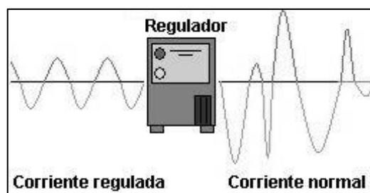
Figura (4.9) Acción de un regulador de corriente.
