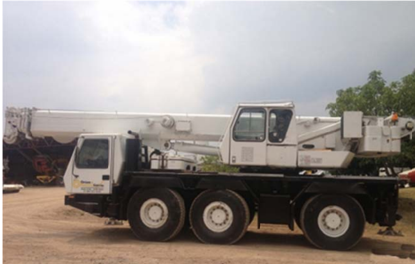
Figura 4.7 Grúa Hidráulica de 50 toneladas.
