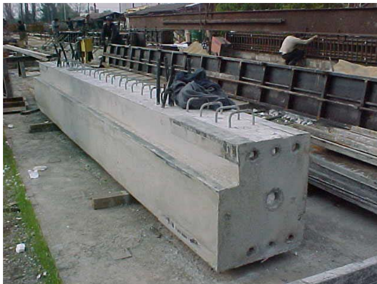
Figura 1.6 Prefabricados con acero de refuerzo simple y postensados.
