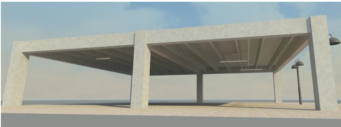
Figura 1.30 Estructuración típica de un edificio prefabricado.
