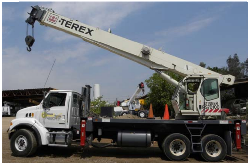
Figura 4.6 Grúa Hidráulica de 35 toneladas.
