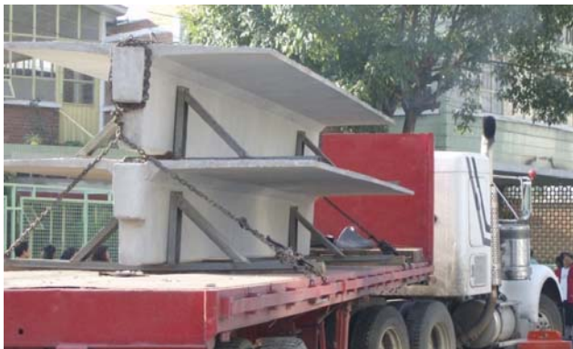
Figura 1.33 Diferentes maneras de transportar los elementos prefabricados.
