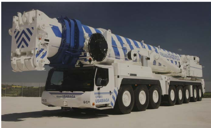
Figura 4.10 Grúa Hidráulica de 500 toneladas.
