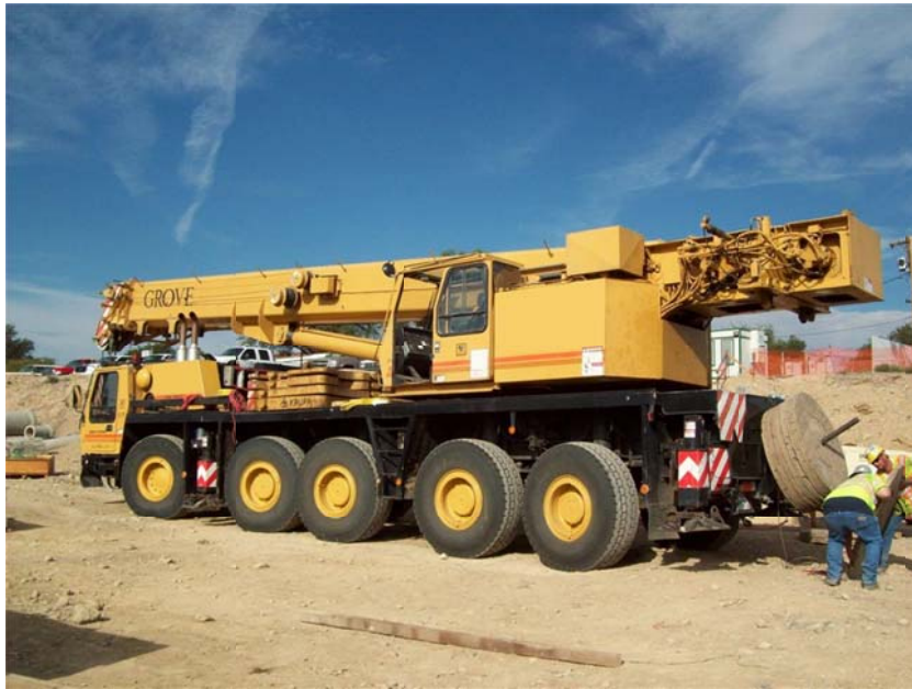
Figura 4.9 Grúa Hidráulica de 100 toneladas.
