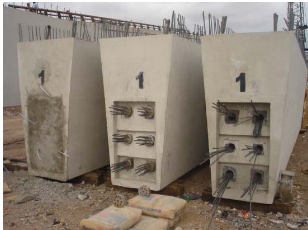
Figura 1.9 Trabes para puente prefabricado y postensado.
