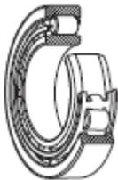
En este tipo de rodamientos los rodillos están en contacto lineal con las pistas de rodadura. Presentan una elevada capacidad de carga radial y resultan muy adecuados para alta velocidad.
