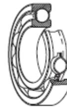
Fig. 4.1.8 Rodamiento de bolas de una hilera
