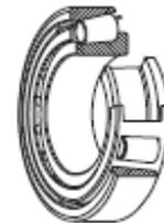
Fig. 4.1.14 Rodamiento de rodillos cónicos.
