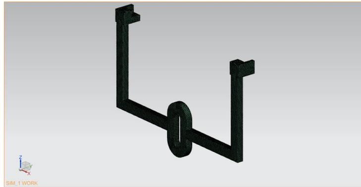
Fig. 4.3.27 Mallado en Brazo Lateral
