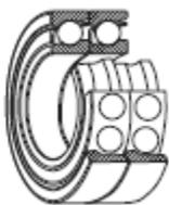
Fig. 4.1.9 Rodamiento de bolas de dos hileras o Duplex
