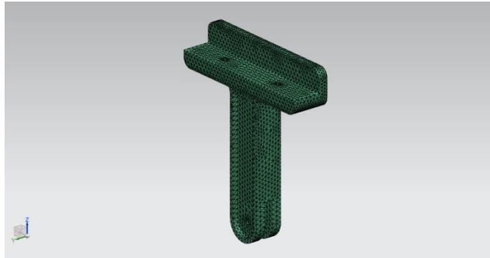
Fig. 4.3.32 Mallado en Brazo Vertical
