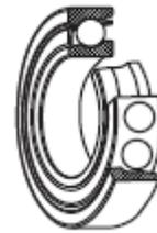
Fig.4.1.10 Rodamiento de bolas de contacto angular
