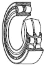
Fig. 4.1.13 Rodamiento de rodillos esféricos.
