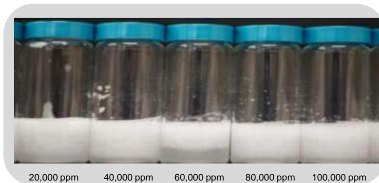
*Figura 6.11 Compatibilidad del tensoactivo T32\* en un barrido de salinidad
