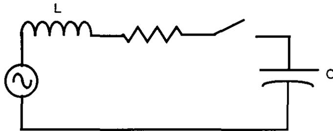
Figura 33 Sistema de energización para un banco aislado
