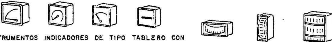
INSTRUMENTOS INDICADORES DE TIPO TABLERO CON VARIOS TIPOS DE ESCALA
