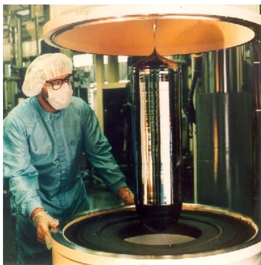
Figura III.11 Lingotes de Si crecidos por el método de Czochralski
