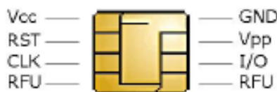
Figura IV.19 Contactos del chip de una tarjeta inteligente
