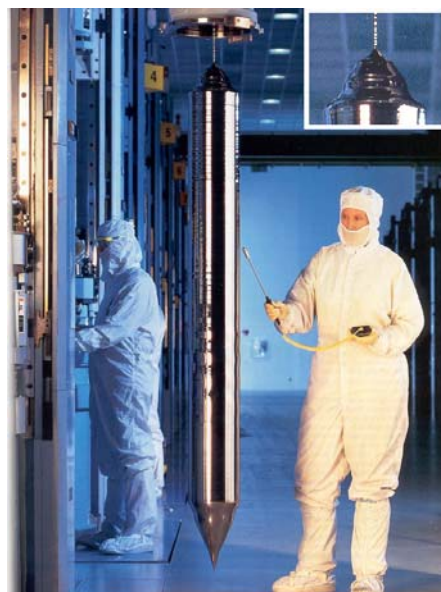
Figura III.11 Lingotes de Si crecidos por el método de Czochralski
