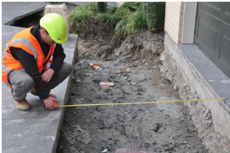
Fig 2.41 a) Grave asentamiento e inclinación de una residencia en Kaiapoi, b) desplazamiento lateral de 1.2 m en la misma propiedad (GEER Association, 2010c)
