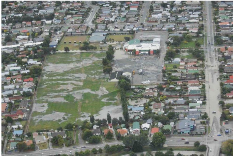
Fig 2.45 Licuación en zona residencial de Christchurch (NCEI, 2015)
