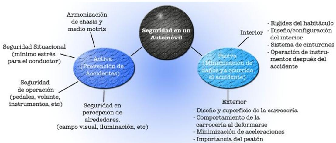
Figura 16. Seguridad en un Automóvil
