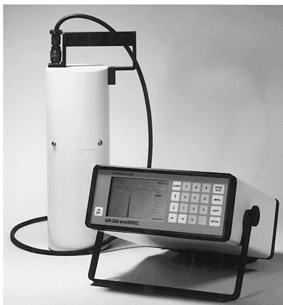
Fig. 6.5. Espectrómetro de rayos gamma, marca Exploranium®.
