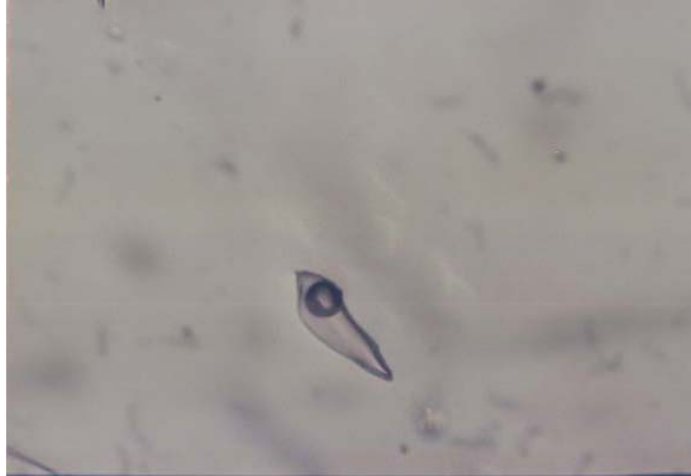
Figura 36. Inclusión primaria tipo I en cuarzo asociado a calcopirita en las vetillas de cuarzo ± calcopirita de la microdiorita en la alteración SCC (tomado de Garza-González, 2007).
