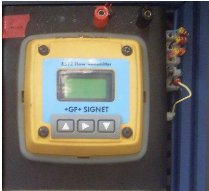
Figura 2.8: Transductor para el sensor de flujo
