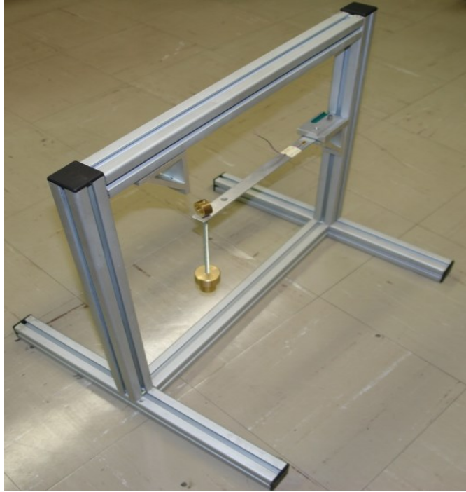
FIGURA 5.4 Marco de carga configurado para pruebas de flexión con viga en cantiléver
