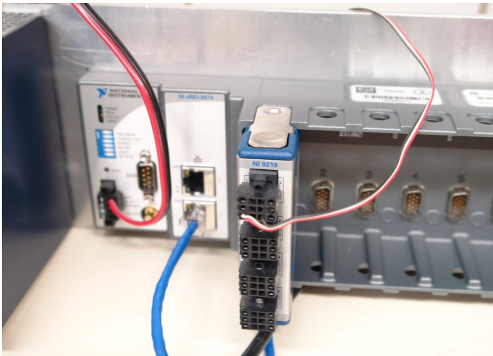
FIGURA 5.3 Configuración de conexiones al chasis cRIO, en el caso de adquisición de una señal
