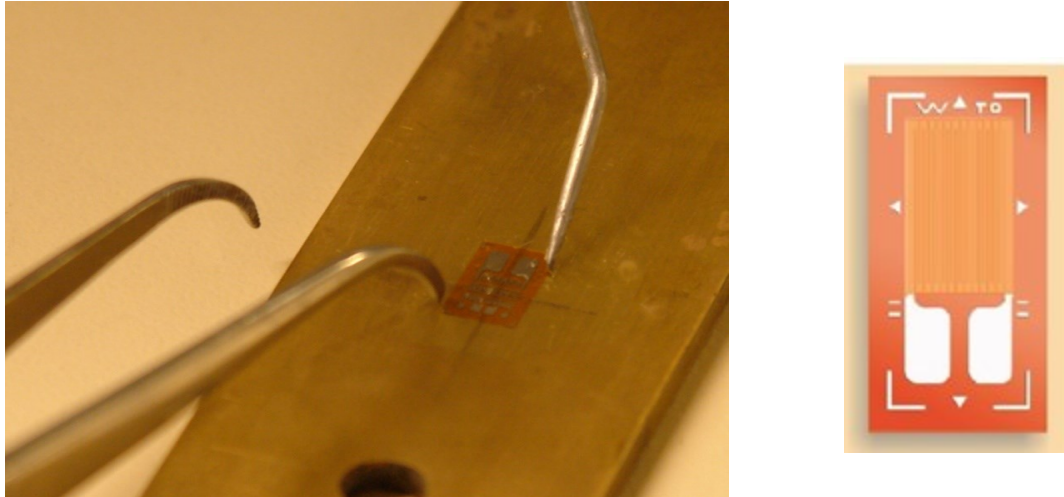
FIGURA A.5 Orientación del extensómetro previa al pegado
