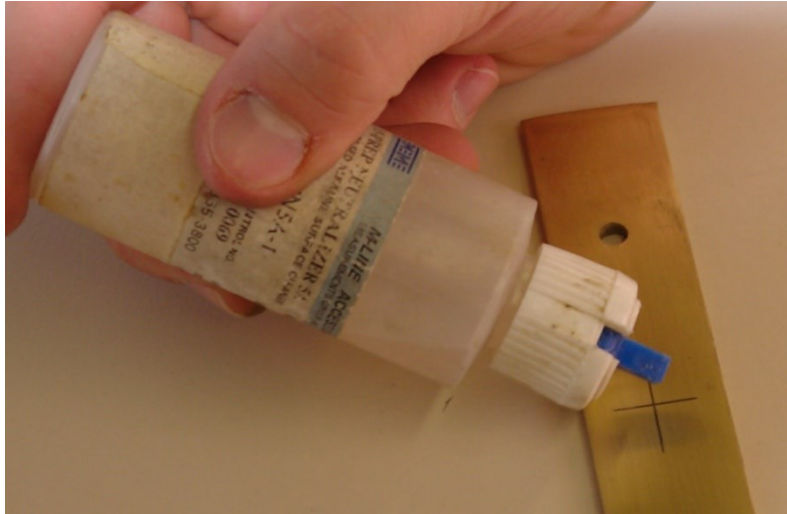
FIGURA A.4 Aplicación de neutralizador sobre la marca de grafito
