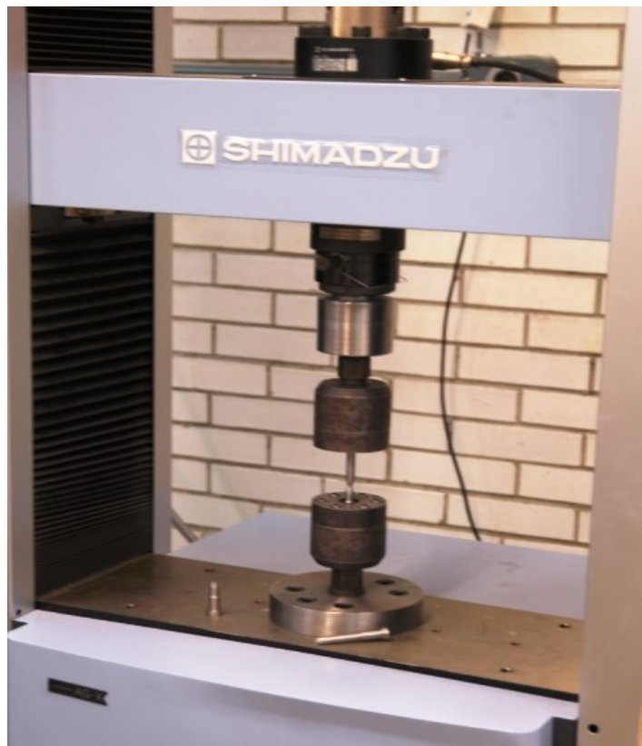
FIGURA 4.2 Disposición del espécimen a evaluar en la máquina universal (especimen cilíndrico)
