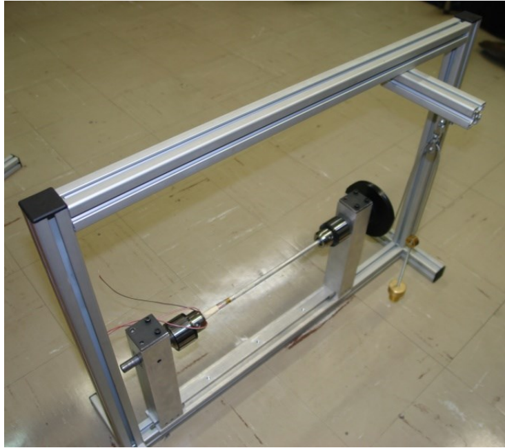
FIGURA 6.4 Disposición de montaje en el marco de carga para torsión
