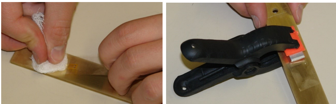
FIGURA A.8 (a) Pegado de la galga. (b) Presión sobre la galga
