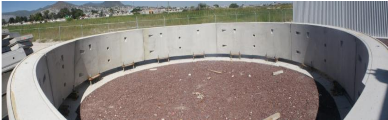
Figura 7. Anillo de dovelas de prueba (CONAGUA, 2010).
