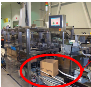
Figura 39 Desplazamiento mediante rodillos muertos
