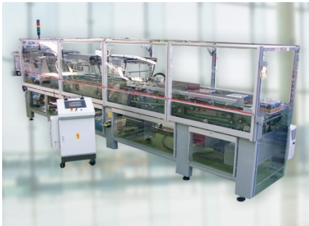
Figura 1 Embandejadora, marca Gebo Cermex.
