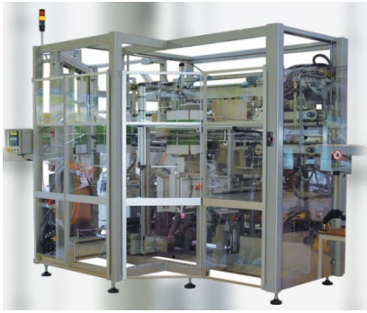
Figura 7 Máquina para encajado inferior, marca Gebo Cemex.
