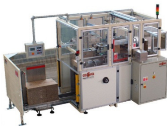
Figura 18 Máquina para formar cajas, marca IMANPACK.
