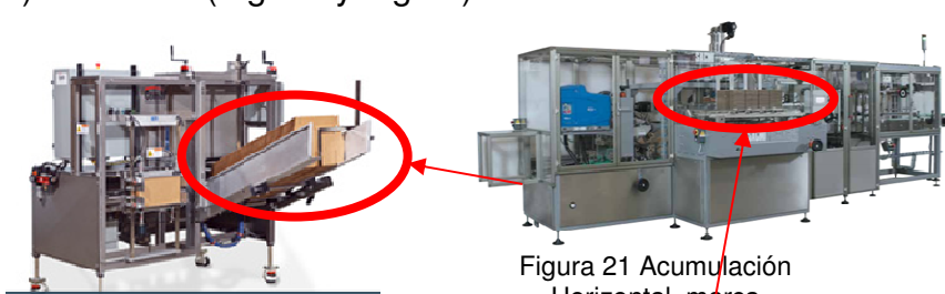
Figura 20 Acumulación inclinada, marca COMBI.
