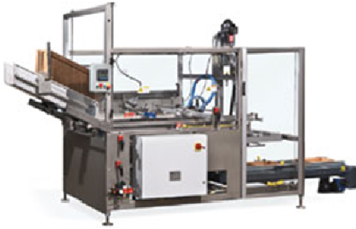
Figura 15 Máquina con sistema de pegado, marca COMBI.
