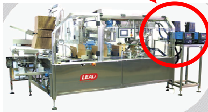
Figura 28 Ubicación típica del tanque de pegamento.
