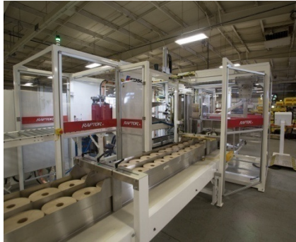
Figura 3 Máquina para encajado lateral, marca (Edson Packaging).
