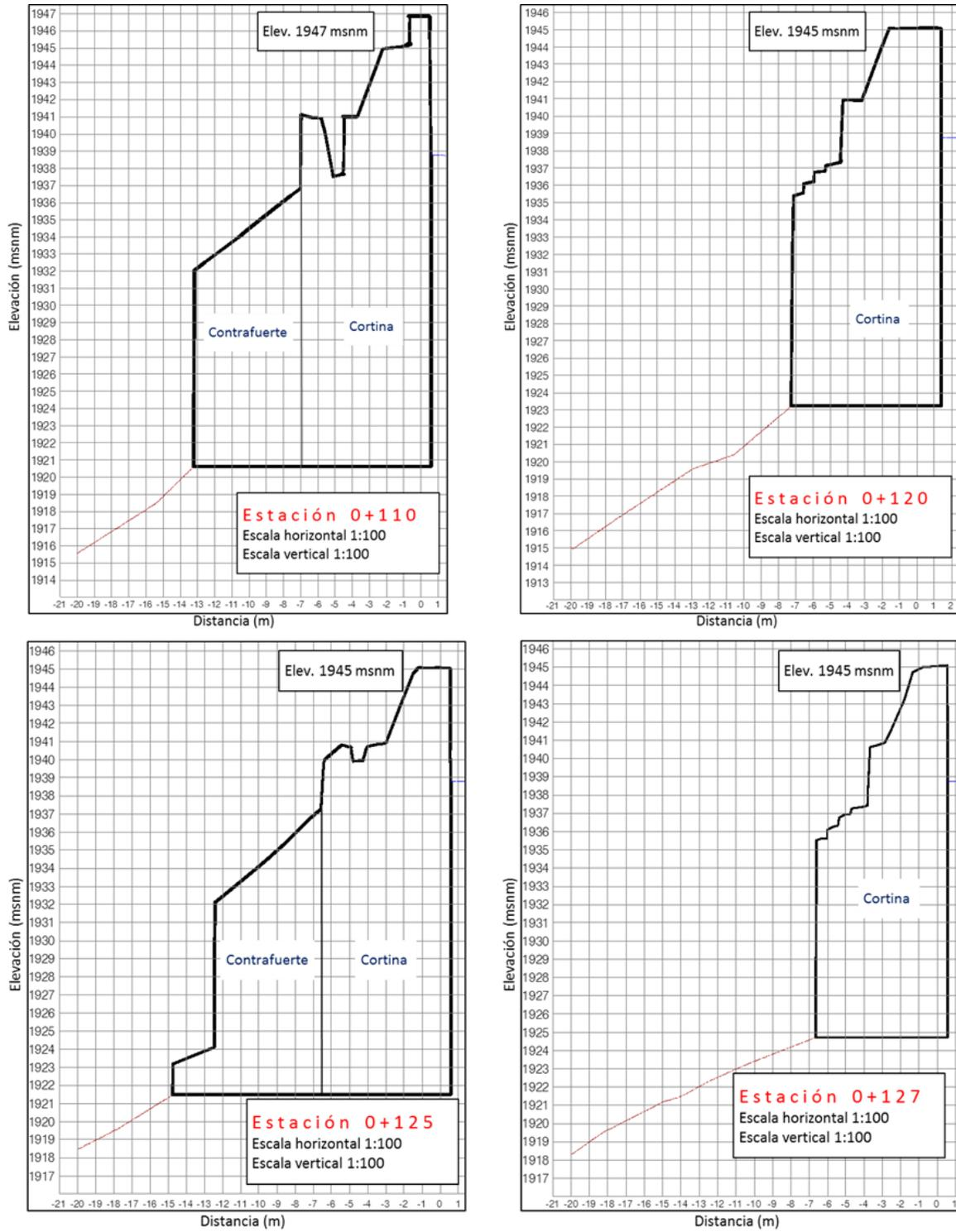
Figura 6.15. Secciones críticas de la presa
