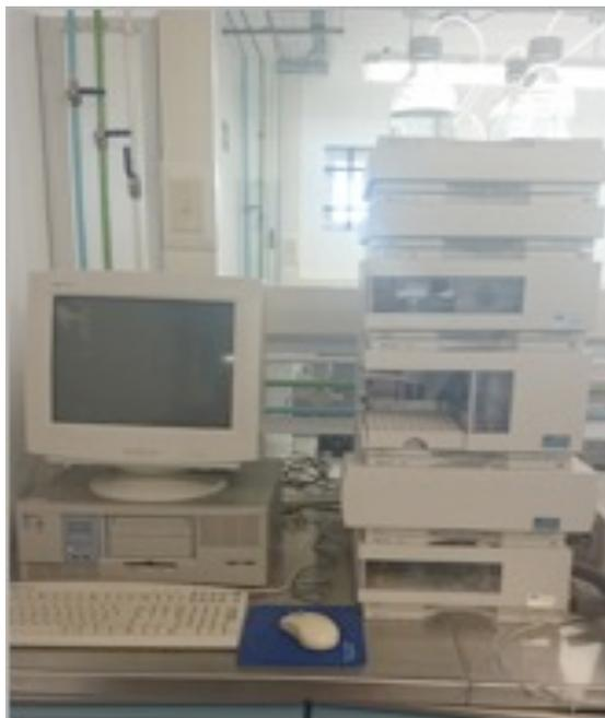
Figura 5.2 Cromatógrafo de líquidos iónicos de alta resolución (HPLC).
