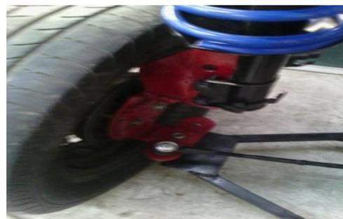
3.4.5 Llanta, disco de acoplamiento-resorte y amortiguador acoplado al chasis
