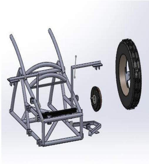
2.7.1 diseño prototipo para sujetar amortiguador
