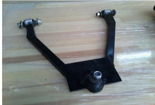
2.6.1 horquilla inferior con base para amortiguador
