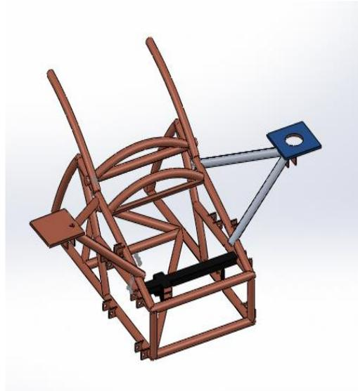
2.7.2 chasis delantero con placa soldada para sujetar amortiguador
