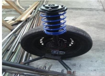
3.3.4 Conjunto resorte amortiguador acoplado al chasis
