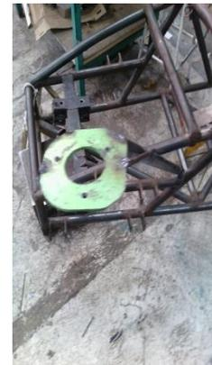
Esta placa de cedula 40 fue barrenada en el centro la cual tiene un diámetro de 9 cm y los tres barrenos que llevan atornillados permitirán ajustar el conjunto masa/resorte amortiguador al chasis de nuestro vehículo el cual va a ser a un único Angulo ya alineado para la llanta, este diseño va de esta forma debido a que la configuración de la suspensión MacPherson forma un triángulo
