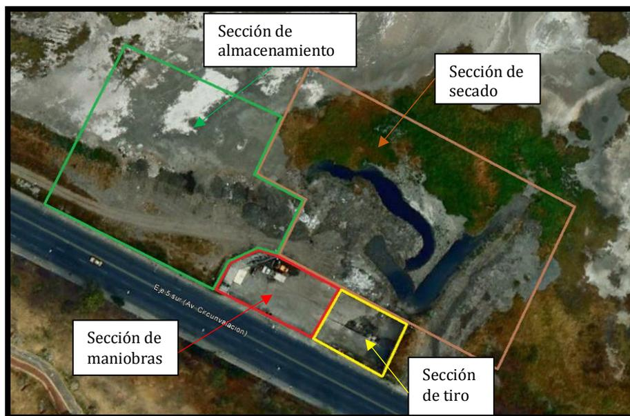
**Figura 4.6.** Distribución de secciones en la zona de transferencia
