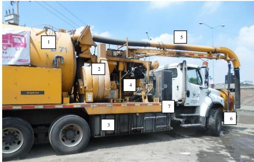
**Figura 1.5.** Partes principales del equipo hidroneumático
