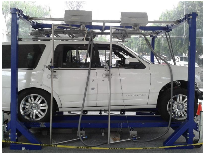
Figura 1.1 Banco de pruebas destructivas para puertas de automóviles diseñado en la Facultad de Ingeniería de la UNAM para la planta de producción de Ford Motor Company en Cuautitlán Izcalli.
