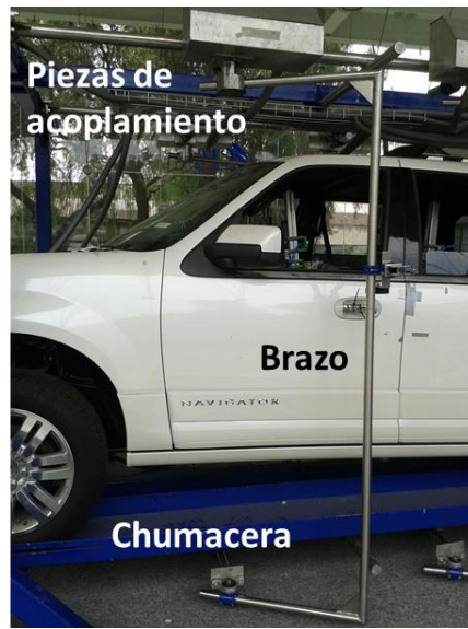
Figura 1.3 Elementos mecánicos que constituyen uno de los sistemas motrices del Banco KLT. El banco de pruebas cuenta con cuatro sistemas motrices, uno dedicado a cada puerta del auto.
