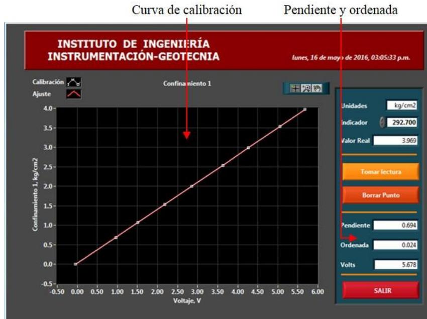
Figura 4.7 Registro de puntos para calibración de un sensor.
