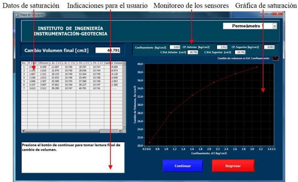
Figura 4.13 Registro de datos en etapa de saturación por contrapresión.
