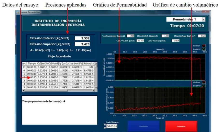
Figura 4.16 Modulo para realizar la etapa de ensaye.
