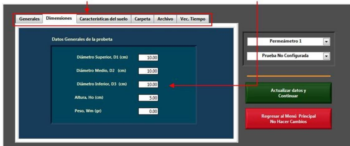
Figura 4.10 Registro de dimensiones de la probeta.
