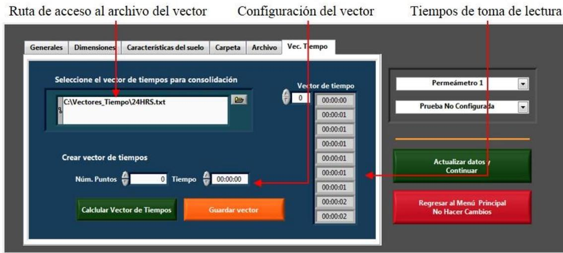
Figura 4.11 Configuración del vector de tiempo para la etapa de consolidación.
