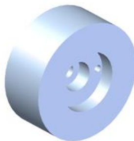
Figura 3.46 Barril. Se encarga de mostrar la magnitud de la profundidad de corte introducida. Esta grabado de manera tal que permite una resolución de una milésima de pulgada.
