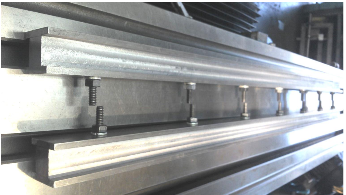
Figura 3.72 Carril en C, piezas por las que se desplaza el mecanismo del sistema de sujeción.
