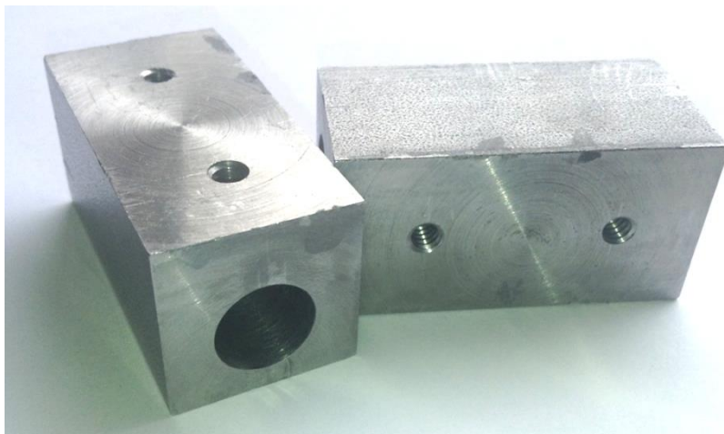
Figura 3.70 Camisa del eje, esta pieza va ensamblada a la "placa base" y es el apoyo para el "eje".
