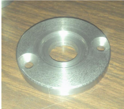
Figura 3.80 Anillo de Barril. Esta pieza sirve para referenciar la profundidad de corte.
