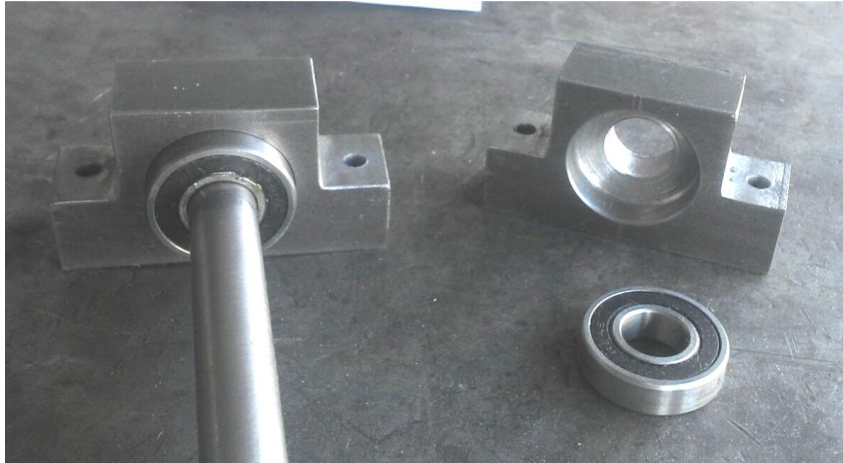
Figura 3.77 Soporte del husillo. Por medio de este se fija el husillo a la mesa base de ensamble.
