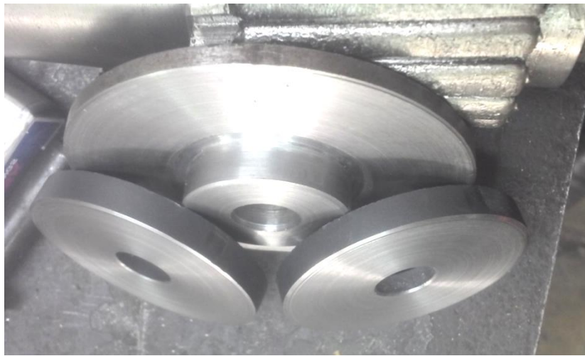
Figura 3.73 Bridas, piezas que se utilizan para sujetar la piedra abrasiva al motor.
