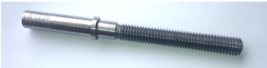
Figura 3.65 Eje roscado. Este eje proporciona a la “cuña” un movimiento lineal, el cual hará deslizar al “seguidor”.
