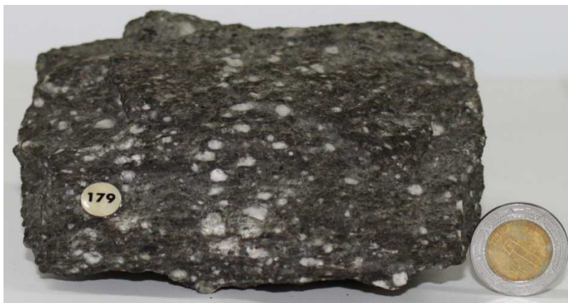
Figura 39. Muestra de mano de milonita, perteneciente al Laboratorio de Geología Física de la Facultad de Ingeniería, UNAM.
