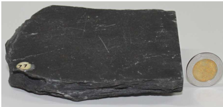
Figura 40. Muestra de mano de pizarra, perteneciente al Laboratorio de Geología Física de la Facultad de Ingeniería, UNAM.
