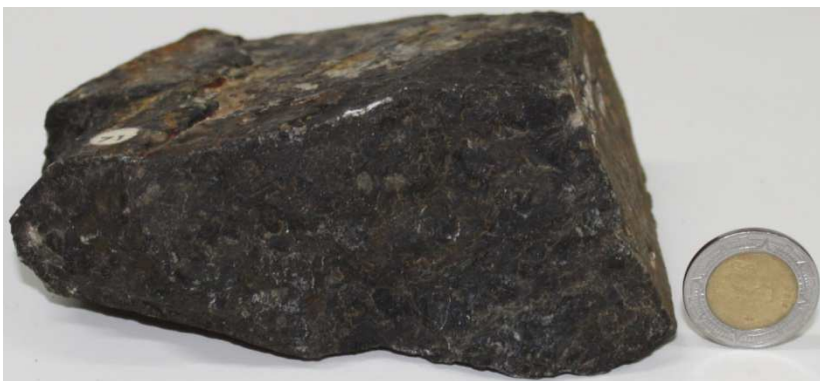
Figura 33. Muestra de mano de corneana, perteneciente al Laboratorio de Geología Física de la Facultad de Ingeniería, UNAM.
