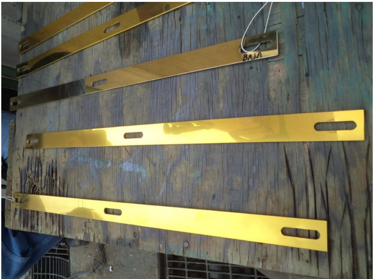
Fig. 11 Testigos de prueba acabado espejo
