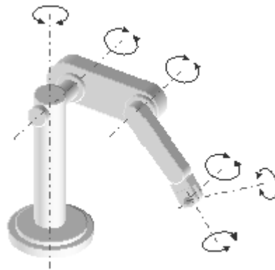
Imagen 1.5 Grados de libertad de un manipulador.
