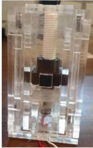
Eslabón adaptable en su posición inicial
