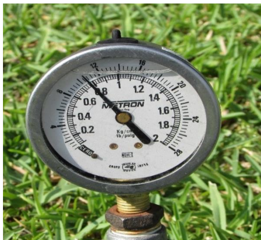
Figura 22: Manómetro utilizado en la medición de la presión en diferentes puntos de una red de agua potable.
