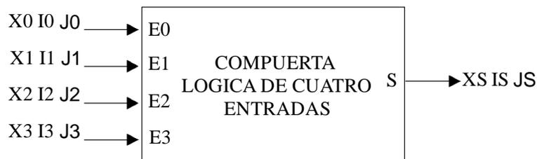
Figura 4.11 Representación genérica del ML de cuatro entradas realizable por el PLM3.
