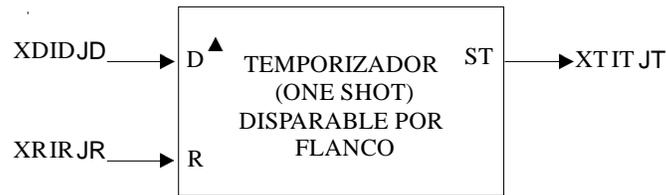
Figura 4.26 Representación genérica de un ML temporizador (one shot) disparable por flanco.
