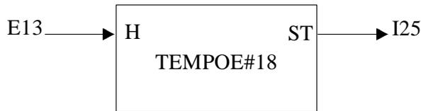
Figura 4.24 Representación a manera de bloque del temporizador del ejemplo 4.12.
