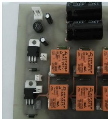
Figura 5.13 Foto de la tarjeta que muestra las fuentes de alimentación del PLM3.
