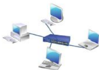
Figura 1.18: Representación física de una Topología Estrella
