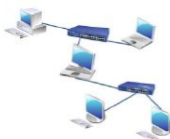
Figura 1.19: Representación física de una Topología Árbol
