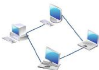
Figura 1.17: Representación física de una Topología Anillo
