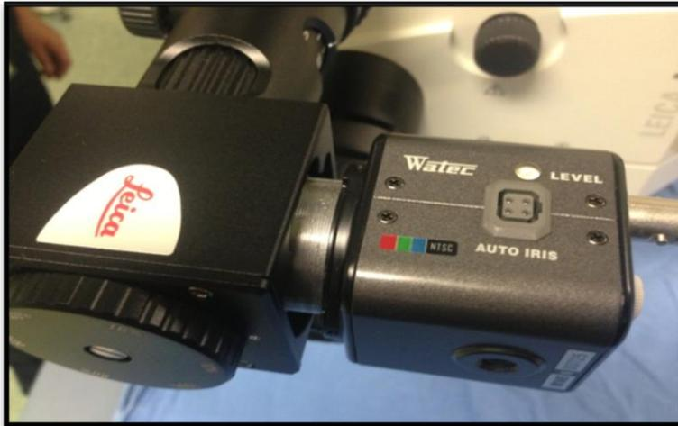
**FIGURA 19: INSTALACIÓN Y PUESTA EN MARCHA DE ADAPTADOR PARA CÁMARA DIGITAL MARCA LEICA CON CÁMARA DIGITAL MARCA WATEC MODELO 231S**
