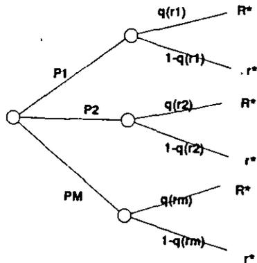
De manera que la probabilidad de tener  $r^*$  es  $p_1q(r_1) + p_2q(r_2) + \dots + p_mq(r_m)$ , y la de  $r^*$  su complemento a 1. La preferencia de la lotería  $L[r_1, r_2, \dots, r_m; p_1, p_2, \dots, p_m]$  es la probabilidad de obtener  $r^*$ , es decir,  $p_1q(r_1) + p_2q(r_2) + \dots + p_mq(r_m)$ . Si observamos esta cantidad, se obtiene sustituyendo cada  $r_i$  por su preferencia  $q(r_i)$  en la lotería y calculando su valor esperado.
