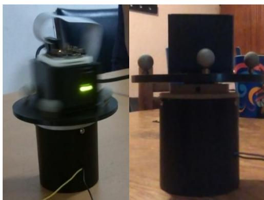
*Figura 61. Sistema de calibración de los giroscopios con la unidad de control y sensor montados.*
