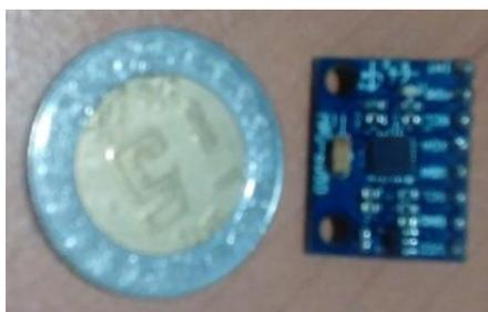
*Figura 17. IMU MPU 9250.*
