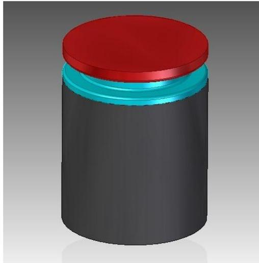
*Figura 35. Ensamble del sistema de calibración de los giróscopos.*
