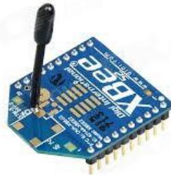
*Figura 16. Módulo Xbee Serie 2.*
