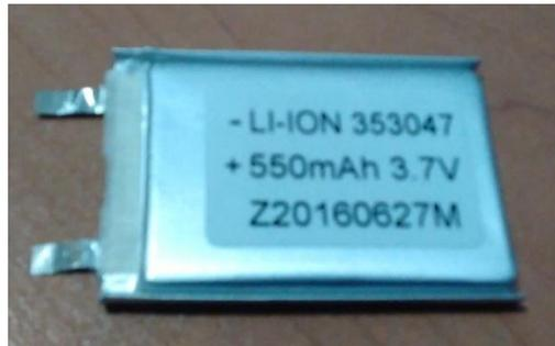
*Figura 48. Batería de iones de Litio utilizada para alimentar el sistema.*
