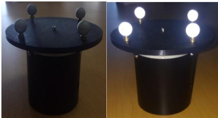
*Figura 60. Sistema de calibración para los giroscopios, diseñado en NX 8.5 y fabricado con ayuda del MADiT de la UNAM.*
