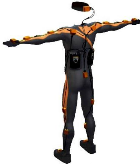
*Figura 13. Traje con sensores inerciales marca Xsens, consta de 17 sensores y es alimentado por 8 pilas AA (Roetenberg, Henk Luinge, and Per Slycke 2015).*
