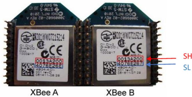
Figura 22. Números de identificación de módulos XBee.
