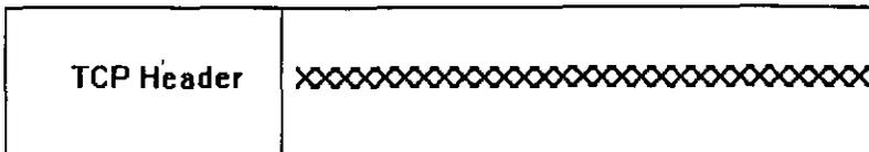
TCP toma el segmento a IP para la entrega como un datagrama. El envío de datos en tramas de tamaño óptimo, hace más eficientes las facilidades de transmisión, por lo que TCP "espera" un tiempo específico hasta que la trama de datos sea del tamaño óptimo, antes de crear un *segmento*.
