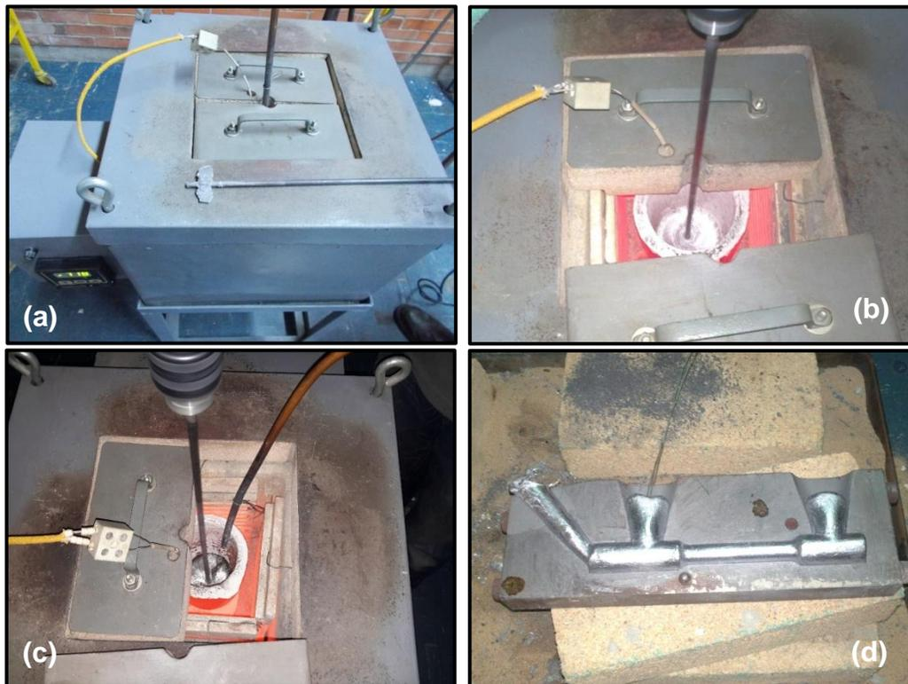
**Figura 23.** Proceso de fundición y agitación para la obtención del CMM. (a) Horno cerrado y agitador de acero recubierto, (b) Vista del proceso de agitación sin protección de Ar, (c) Igual que (b) con protección de Ar, (d) Obtención de pieza solidificada en forma de probeta de tensión.
