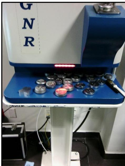
**Figura 16.** Espectrómetro de emisión óptica GNR Óptica modelo S4 Solaris CCDNF.
