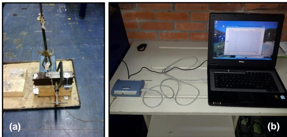
**Figura 25.** Medición de tiempos de solidificación. (a) Arreglo para colocación de termopar y (b) dispositivo de adquisición de datos, tarjeta DAQ y computadora portátil.
