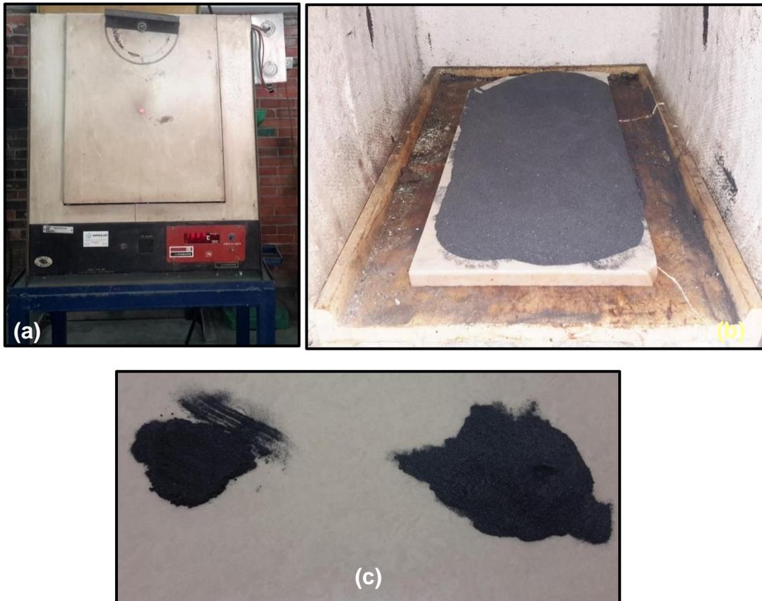
**Figura 17.** Oxidación térmica del SiC. (a) Mufla Lindberg 51891 donde fue realizada la oxidación. (b) Sustrato con SiC después de la oxidación térmica. (c) A la izquierda SiC con Tratamiento térmico y a la derecha SiC sin tratamiento térmico.
