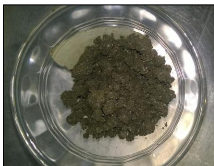
Figura 41. Muestra de suelo natural + rocío de nanosílice
