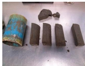
Figura 27. Tubo Shelby de la muestra de suelo No. 3, CH (arcilla de alta plasticidad)
