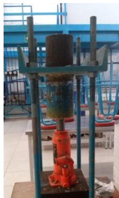
Figura 31. Extracción de la muestra del tubo Shelby
