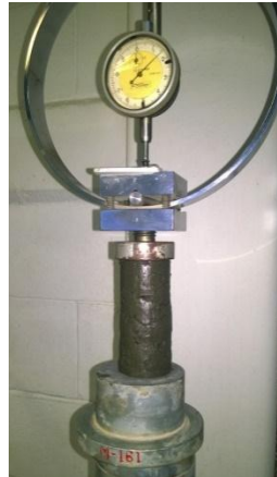
Figura 42. Probeta de suelo ensayada en la máquina de compresión simple
