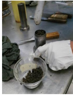
Figura 32. Molde para la reconstitución de las probetas a ensayar a compresión simple
