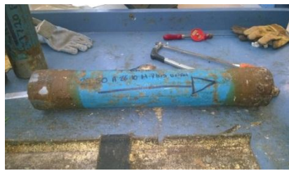
Figura 23. Tubo Shelby de la muestra de suelo No. 1, MH (limo arcilloso de alta plasticidad)
