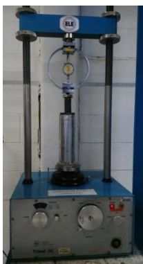
Figura 29. Ensayo de compresión simple
