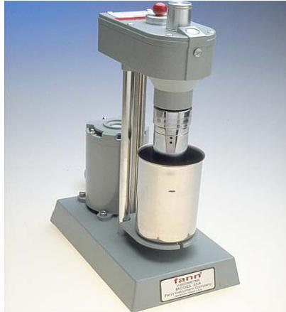
Fig. 4. Viscosímetro de indicación directa típico.
