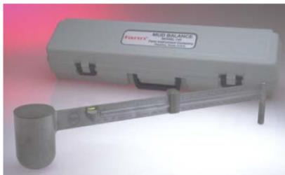
Fig. 1. Balanza de lodos (escala vertical)
