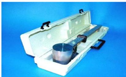
Fig. 2. Balanza de lodos (escala horizontal).
