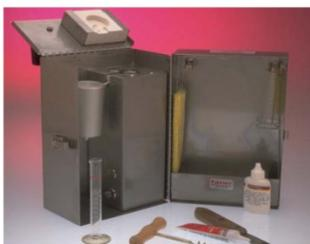
Fig. 7. Retorta para determinar sólidos, aceites y agua.
