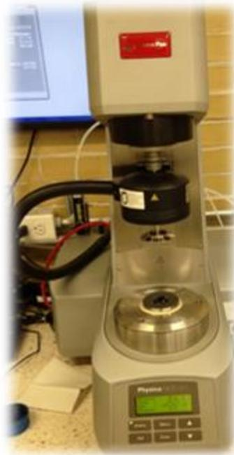
**Figura 3.1** Reómetro Anton-Parr MCR-301.
