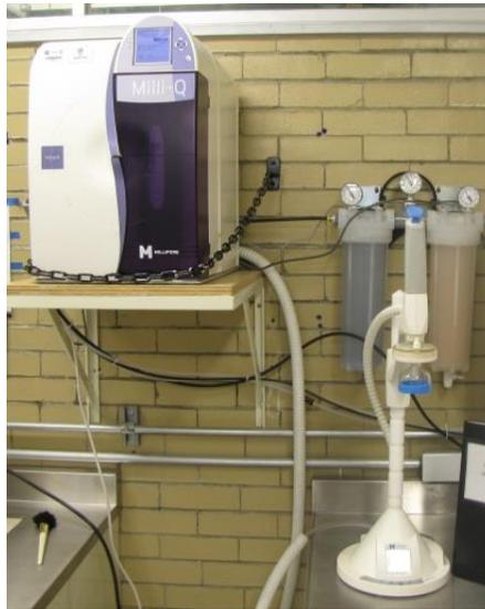
**Figura 3.6** Sistema para el tratamiento del agua
