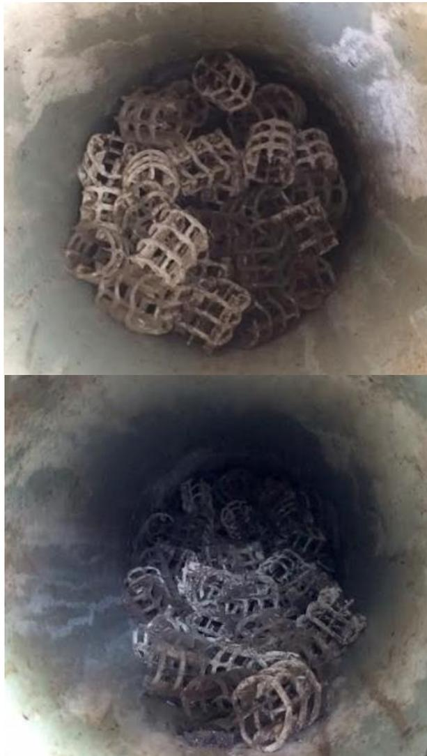
**Figura 8.1.** Azufre elemental depositado en el material de empaque de la columna de desorción
