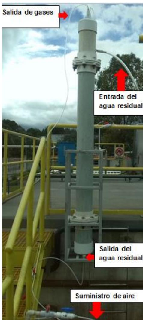
Figura 4.4. Columna para la desorción del biogás
