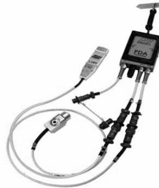
Figura 4-9 Transductores de fuerza y aceleración PDA-8G
