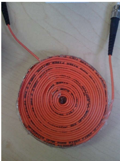
Figura 2.1 Arreglo en fibra óptica multimodo.
