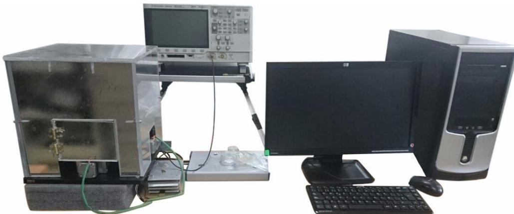
*Figura 4.24. Microscopio de Barrido por Luz*
