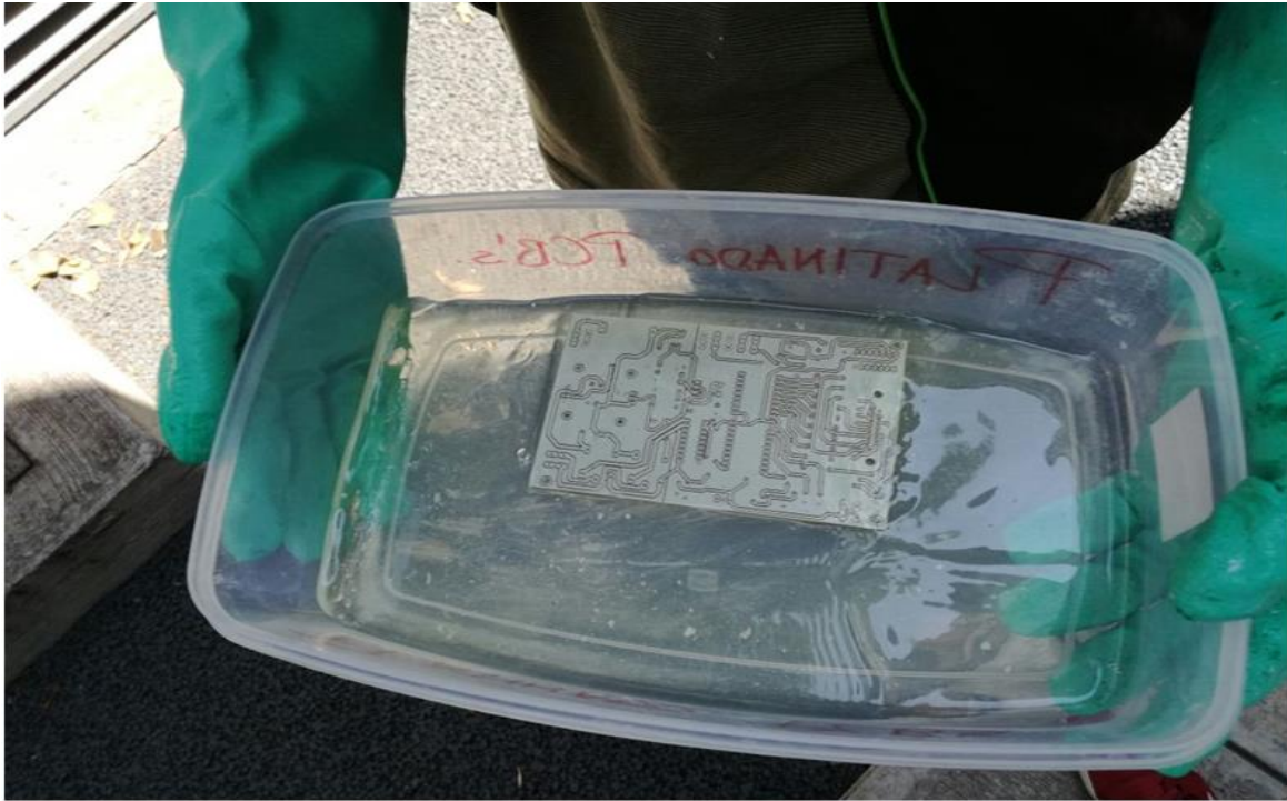
Ilustración 79. Proceso de platinado en tarjeta.
