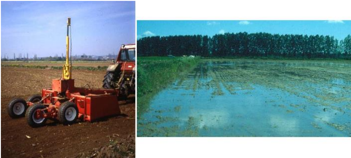
Figura 14 - Equipo de nivelación por láser y parcela nivelada con dicho equipo (Santos Pereira, L. et al., 2004)
