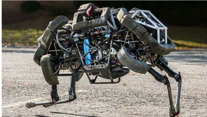
Figura 2.10: WildCat, robot capaz de galopar a grandes velocidades (Boston Dynamics, EU)
