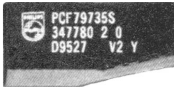
Fig. 3.7 Ejemplo de un Tag encapsulado en plástico. [Propiedad de Philips Electronics B.V.] [8]
