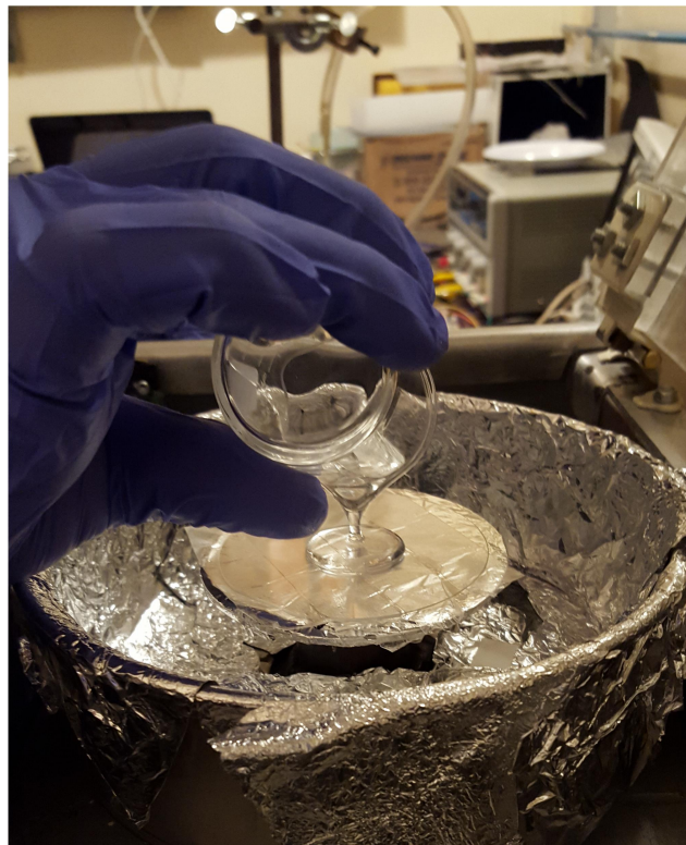
Figura 3.3 Spin coater para PDMS del Laboratorio de Micro y Nano Tecnología de la Facultad de Ciencias.
