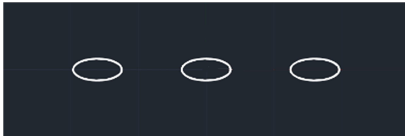
Figura 3.2 Patrón de microcanal delimitante del área no adherible.
