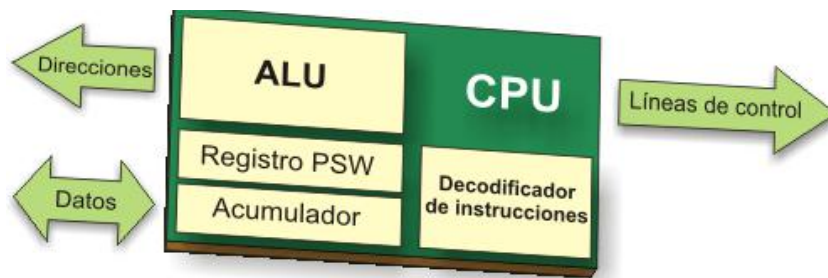
Figura 12 - Circuitos que componen a la CPU.
